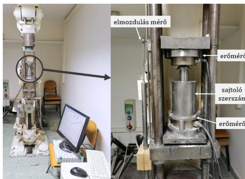
1. ábra: Az erő- és elmozdulás mérővel felszerelt sajtológép
